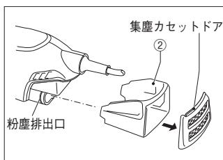
本体後ろ側の粉塵排出口へ集塵ダストカセット（②）を取り付けてください。集塵カセットドアを取り付け/取り外しすることで、カセット内の粉塵を取り出すことができます。
