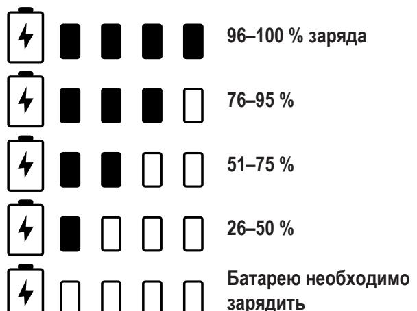
**Примечание.** Светодиоды индикации состояния заряда отображаются только при нажатии кнопки индикации состояния заряда.
